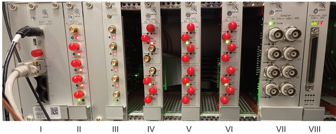
Figure 59: UniFreiburg-Bermuda Variant. From left, I) Kasli, II) Urukul v1.3, III) Urukul v1.5, IV) DIO - TTL 4 inputs, 4 outputs, V), VI) DIO - TTL all outputs, VII) ADC - Sampler, VIII) DAC - Fastino.
