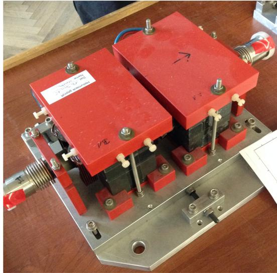
**Abbildung 3.1:** Schneller Wedler. Er besteht aus zwei hintereinanderliegenden Spulen für X- und Y-Richtung, montiert auf eine Justageplatte.
