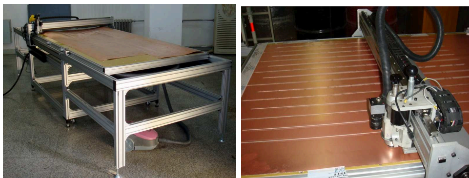
图 3.15: 读出条刻录机。左图是全貌, 右图是刻录头的细节显示
