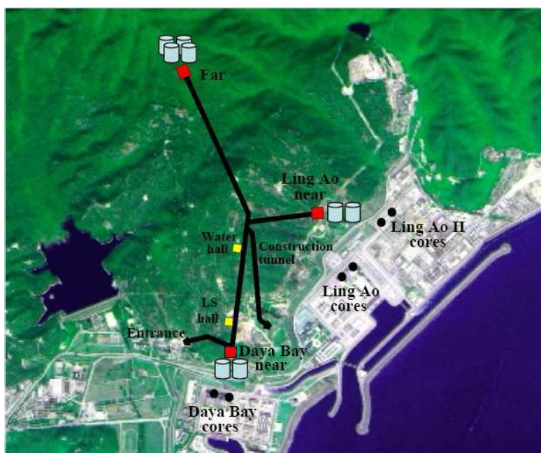
图 2.2: 大亚湾反应堆中微子实验的实验点设置和反应堆位置示意图。图中标示出了三处反应堆的位置，两个近点各两个柱形探测器，远点有四个圆柱形探测器，八个探测器完全等同。三个实验点由隧道相连（图中粗黑线）。
