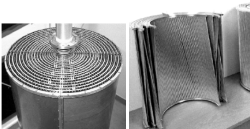
Rysunek 4.4. Komora dryfowa MDC. W lewym panelu pokazano całą zmontowaną MDC wewnątrz osłony Al-Be. W prawym panelu natomiast przedstawiono jedną jej połowę. Zdjęcia zaczerpnięto z pracy [43].
