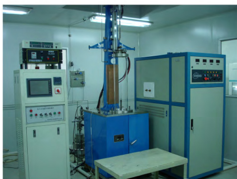
图 4 (在线彩图) 自行设计的单晶炉
