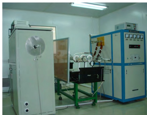
图 3 (在线彩图) 自行设计的区熔设备
