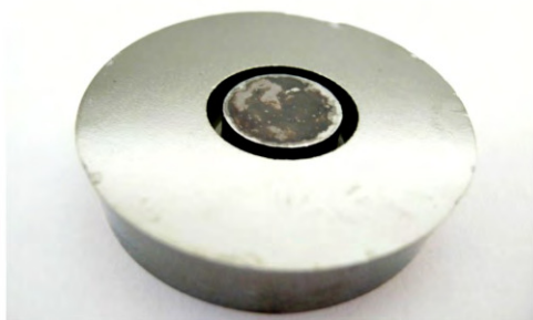
图 2 (在线彩图) 制备好的同轴型高纯锗探测器
