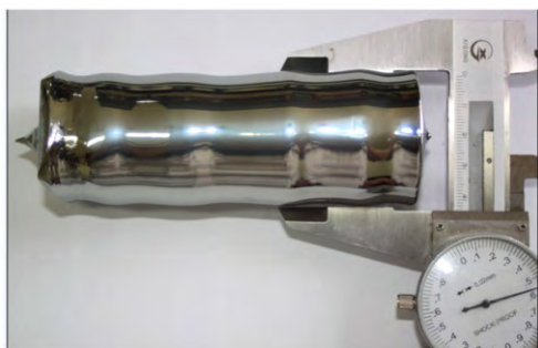
图 1 (在线彩图) 一根拉制出的高纯锗单晶棒
