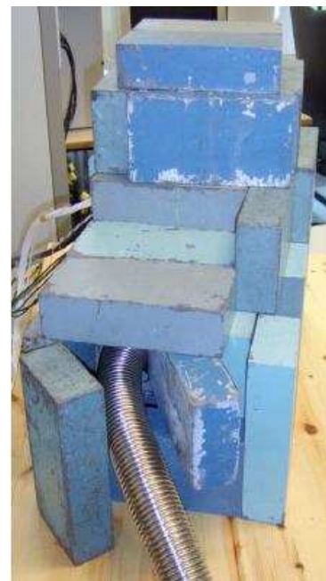
Abbildung 7.8: Rechts: Detektor mit Bleiummantelung und kleiner Öffnung für Vakuumversorgung.
