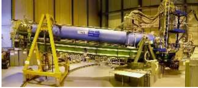
Abbildung 3.3: Der CAST Magnet im Original. Zu sehen ist der Magnet selbst und die bewegliche Plattform. Die Röntgendetektoren sind an den beiden Enden des Magnetes angebracht ( CAST Homepage , 2006).
