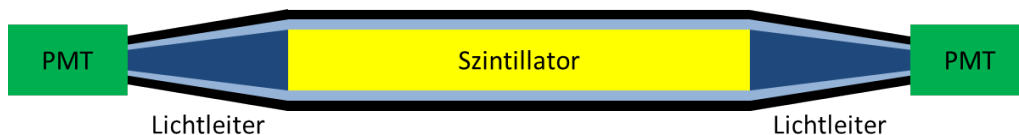
Abbildung 5.7: Schematische Zeichnung eines beidseitig ausgelesenen Szintillators und Darstellung der Oberflächenübergänge zur umgebenden Lufthülle und Aluminiumfolie.
