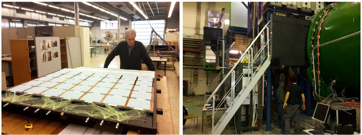
Рисунок 1.23: Фотографии годоскопа MUV0: в чистой комнате (ЦЕРН) перед транспортировкой в экспериментальный зал (слева) и установленный в экспериментальном зале (справа).
