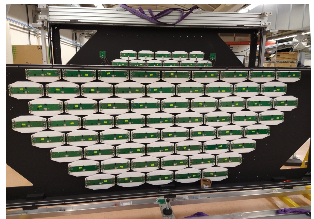
Рисунок 1.42: Верхняя часть детектора в чистой комнате после установки всех счетчиков и подключения сигнальных кабелей и шлейфов питания.
