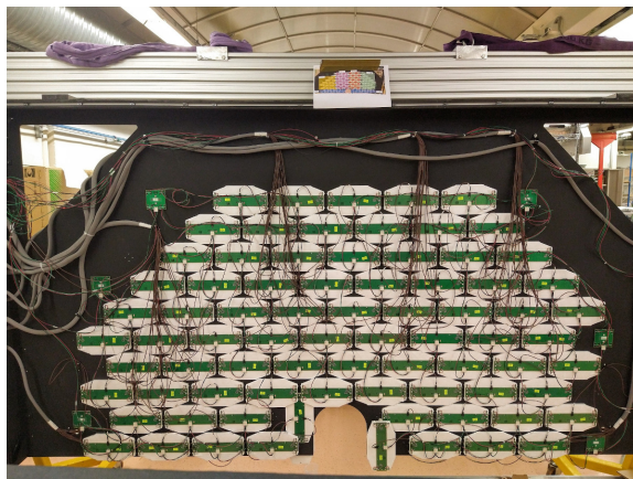
Рисунок 1.42: Верхняя часть детектора в чистой комнате после установки всех счетчиков и подключения сигнальных кабелей и шлейфов питания.
