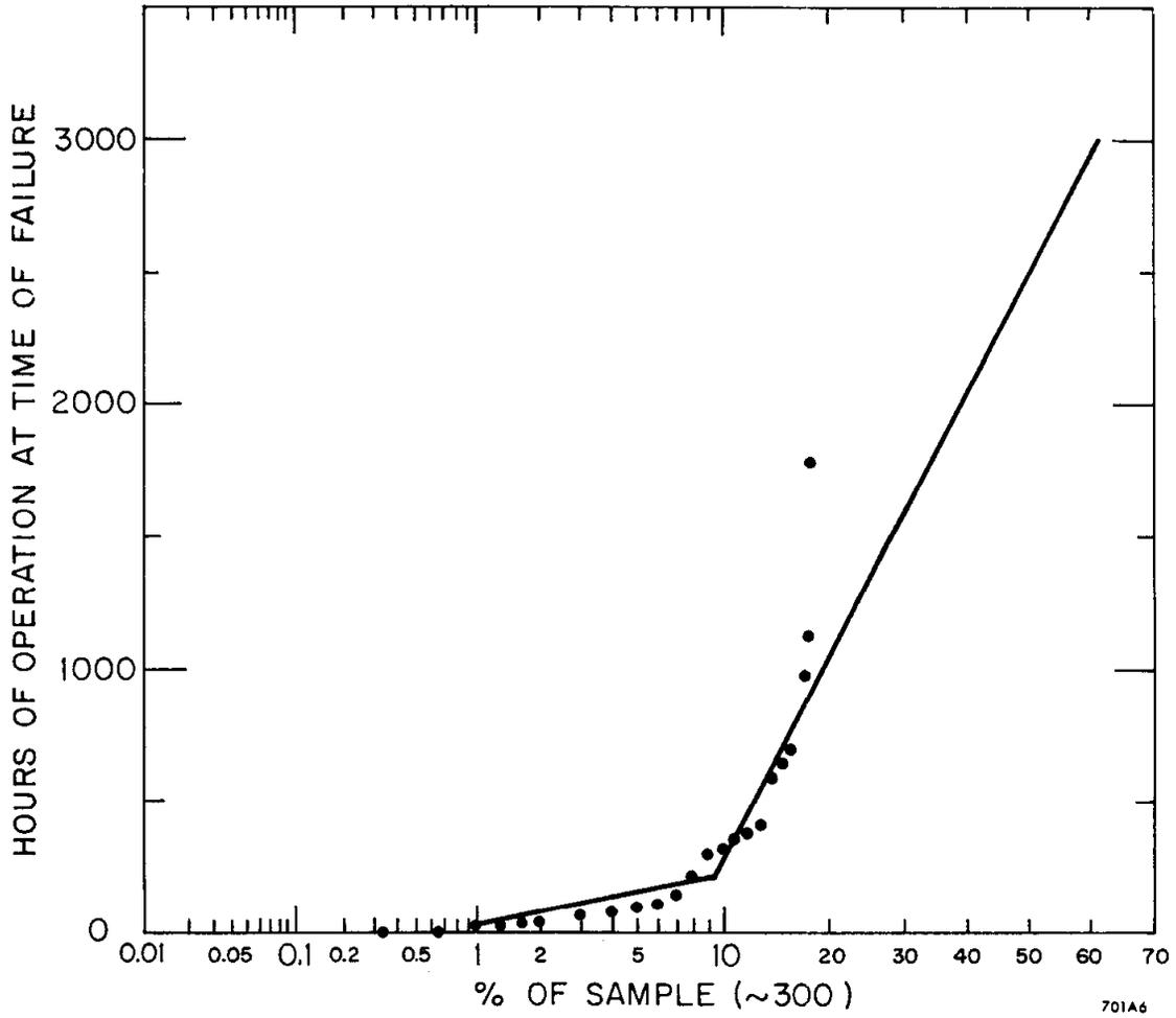
ALL KLYSTRONS - FAILURES DISTRIBUTION ON 10/1/66
