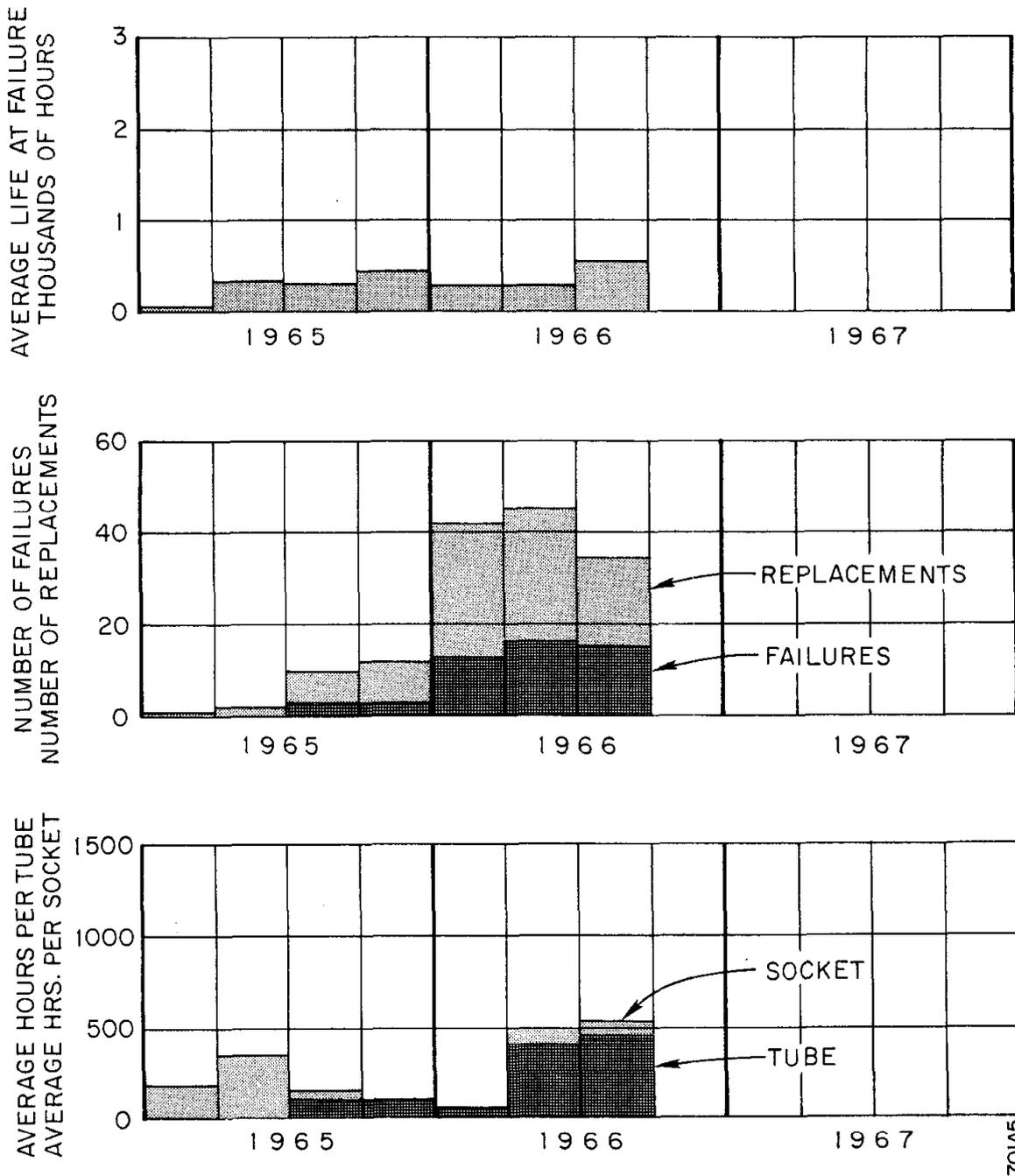
Fig. 14--KLYSTRON QUARTERLY OPERATING EXPERIENCE, ALL HIGH POWER KLYSTRON VENDORS
