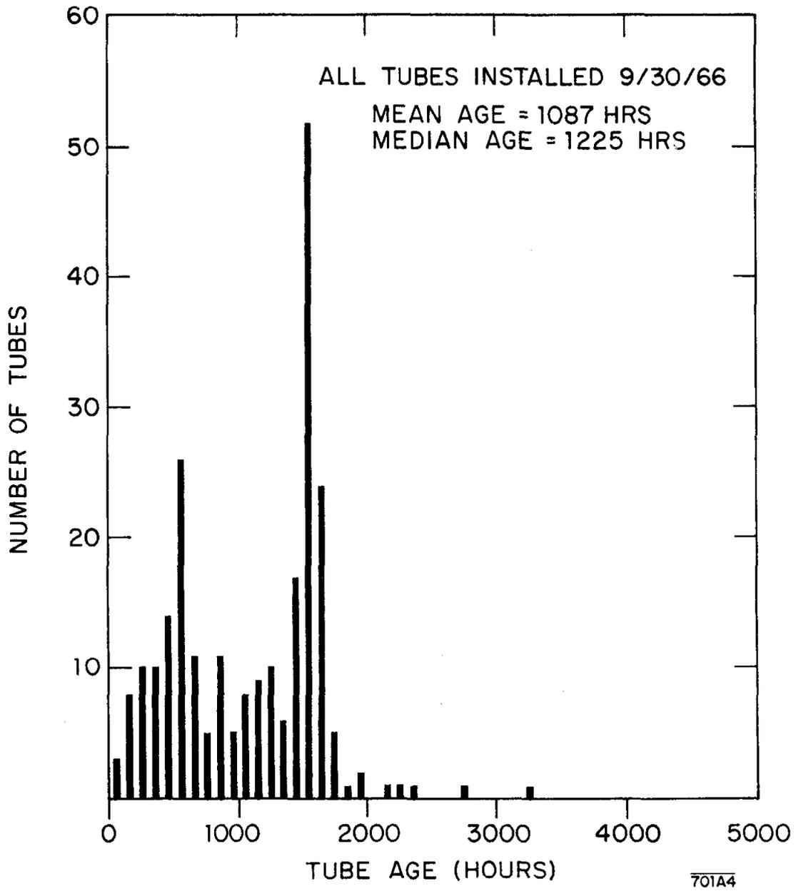
FIG.13- KLYSTRON AGE DISTRIBUTION (100-HOUR INCREMENTS)
