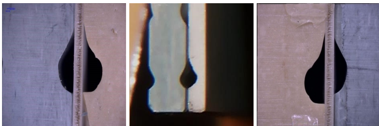
Рисунок 3.15: Результаты сканирования торцевой поверхности стеков камер с помощью цифрового микроскопа высокой точности: а) камера со стеклом собранным с использованием высоковольтного электрода изготовленного методом прессформы (ALICE TOF R&D) и электрода изготовленного на станке с ЧПУ; б) камера со стеклом из обоих фрезерованных на станке с ЧПУ электродов на базе керамик Al_2O_3 и SiC/Si_3N_4 ; в) пример ошибки позиционирования инструмента в плоскости заготовки или неправильного заглубления режущего инструмента.
