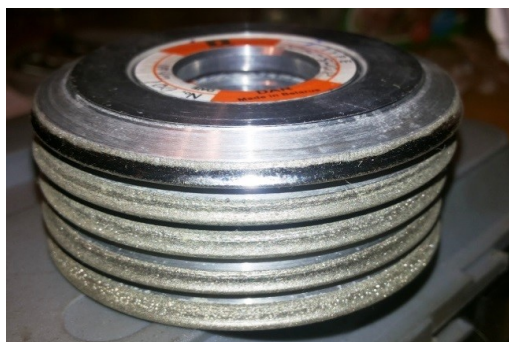
Рисунок 3.11: Режущие диски с рабочей кромкой с напылением из алмазного синтетического микропорошка на никелевой связке, сверху находится использованный диск.
