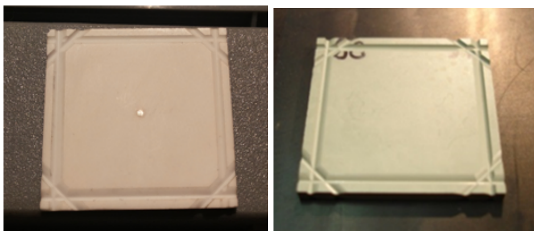
Рисунок 3.12: Изготовленные керамические электроды из алюмооксидной (слева) и нитрид-карбидной (справа) керамики.
