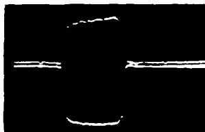
Рис. 4. Осциллограммы импульса тока с катода (1), импульса ускоренного тока (2) и отбрасываемый импульса (3)
