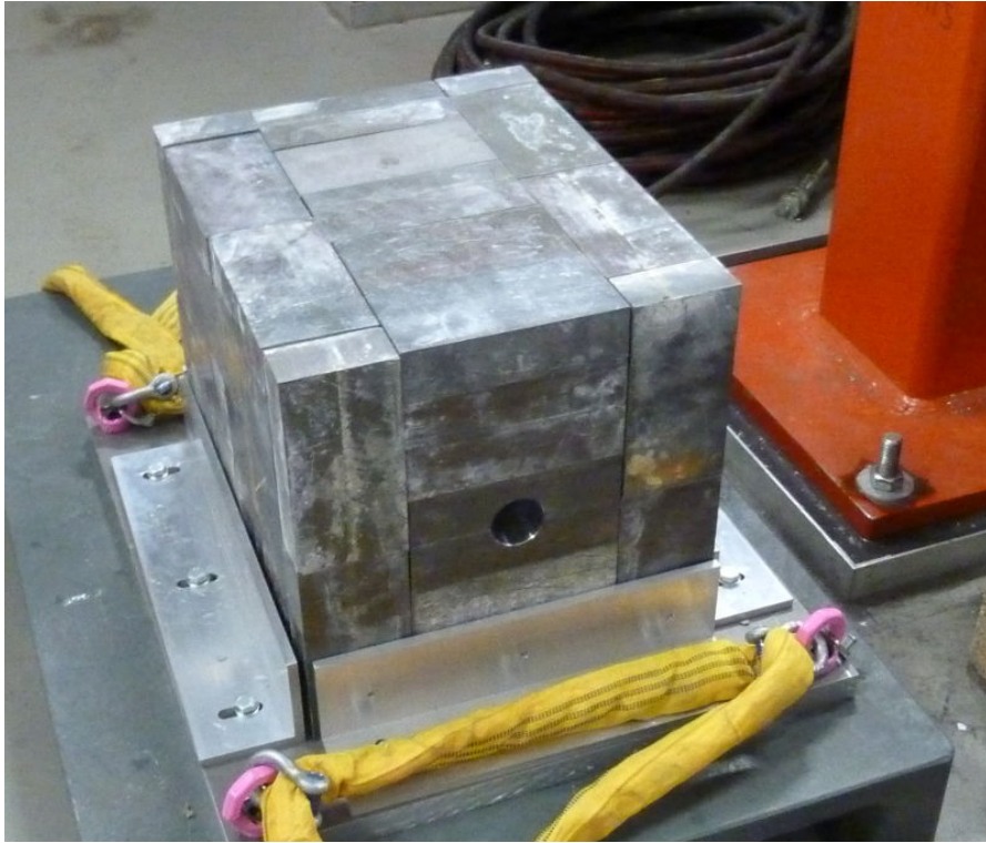
Abbildung 13: Photo des Photonenstrahlfängers bevor er hinter dem Spektrometer platziert wurde, ohne die zur Stabilisierung angebrachte Aluminiumverschalung. An der Vorderseite ist die Bohrung zu erkennen, durch die die Photonen in das Innere des Strahlfängers gelangen.
