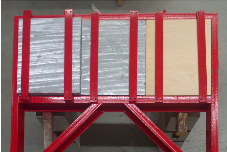
Abbildung 59: Photo der zum Abstoppen von Positronen verwendete Bleiwand vor dem Einbau in das KAOS-Spektrometer. Zusätzlich zu einer Platte der Abmessungen 1500 \times 600 \times 100 \text{ mm}^3 können die drei einzelnen Segmente jeweils durch den Einbau weiterer Bleiplatten in der Dicke verändert werden.
