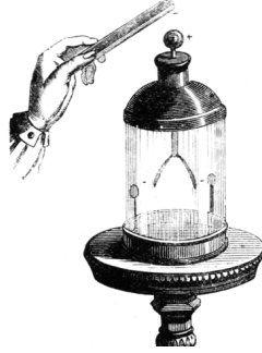
FIGURE 1.1 – Principe de l'électroscope.
