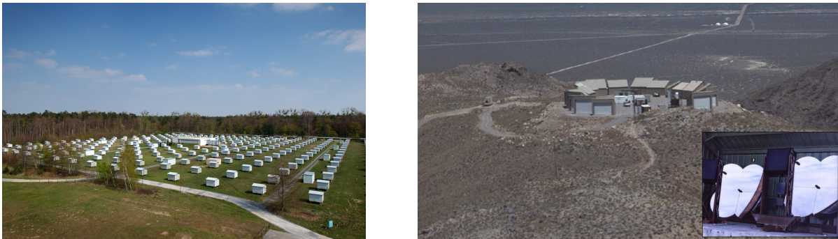
FIGURE 1.12 – Exemples des deux types de technique pour la détection des rayons cosmiques de haute énergie : le réseau de surface de KASCADE (à gauche) et les télescopes à fluorescence de HiRes (à droite).
