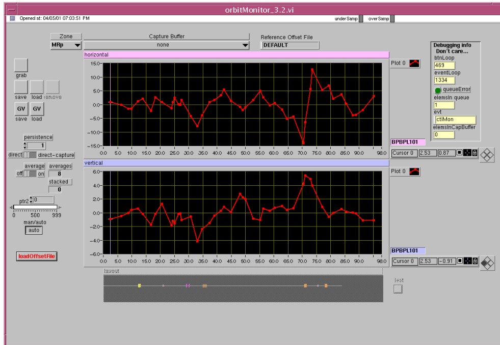
Figura 4.2: La finestra del programma del sistema di controllo di Dafne per l'acquisizione delle orbite degli Anelli Principali.
