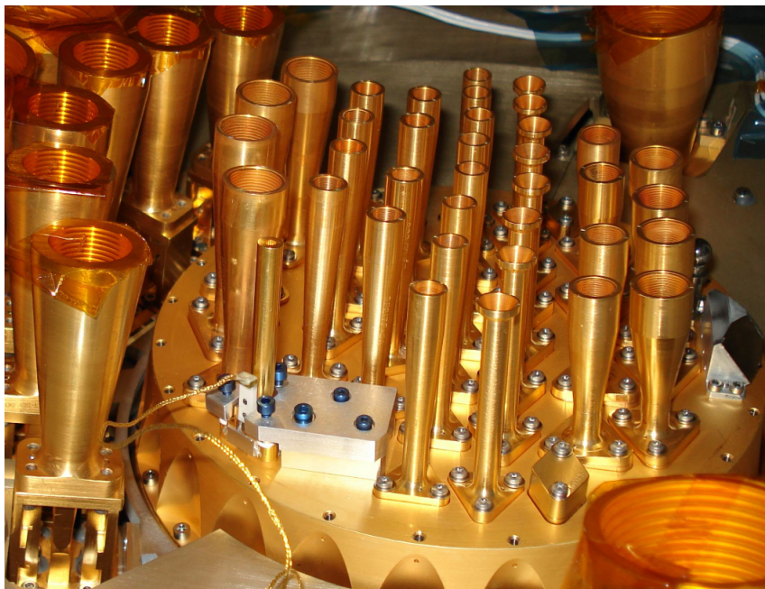
FIGURE 7.7 – Photographie du plan focal de l'instrument HFI. On voit également quelques guides d'onde de LFI. Crédit : ESA / Planck HFI-LFI consortium. [Lamarre 2010]
