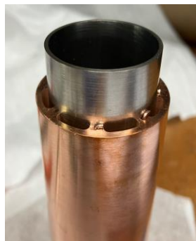
(d) Inner conductor brazing test
