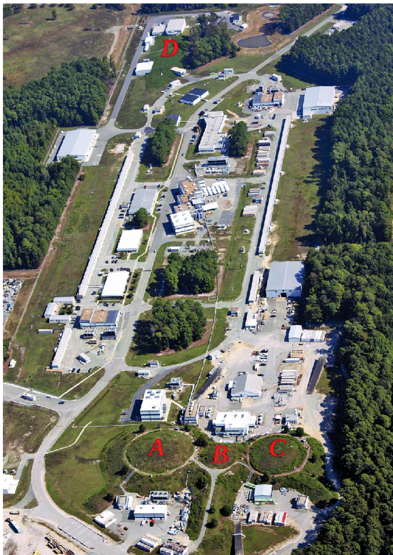
Abb. 2 Der Elektronenbeschleuniger am JLab, mit drei Experimentierhallen A, B und C am unteren Bildrand und Halle D oben links im Bild. Der Strahl umrundet den Beschleuniger fünfmal und erhält dabei jedes Mal einen Energieschub bis zu 2,2 GeV. Dadurch erreicht er eine maximale Energie von 11 GeV, mit der er in die Hallen A, B, C gelenkt wird. Die Elektronen, die zur Halle D geleitet werden, erhalten einen zusätzlichen Energieschub, der die Energie auf 12 GeV erhöht.
