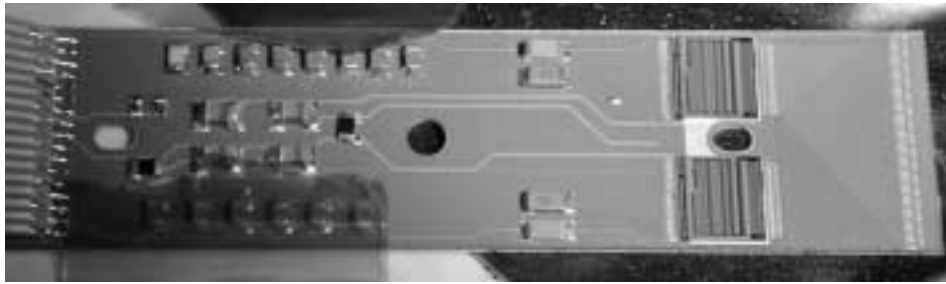
Abbildung 33: Oberseite des Hybrids. Auf der linken Seite befindet sich ein Kaptonkabel für die Signalleitungen und Kontrollsignale der Chips. Ganz rechts liegen sich die Bondpads, welche mit den Streifendetektoren verbunden werden. Ebenfalls rechts befinden sich die beiden Auslesechips des Typs VA2_TA.
