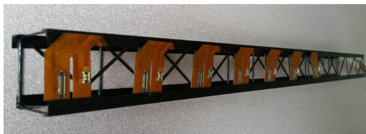
FIGURE 57 – Tests d'intégration des circuits flexes conçus au LAPP dans la structure mécanique de type TRUSS développée par l'Université de Genève et le CERN.
