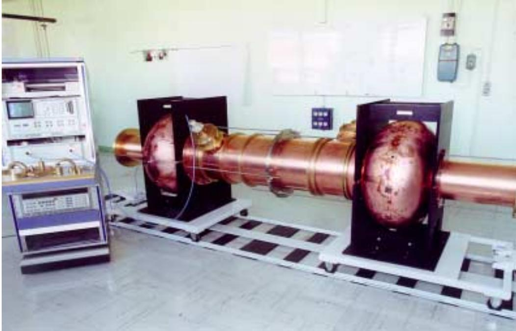
FIG. 1.6 – Prototype des cavités SOLEIL en Cuivre
