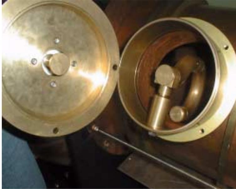
FIG. 1.8 – Installation du coupler dipolaire sur le tube de la cavité, la boucle est perpendiculaire à l’axe faisceau
