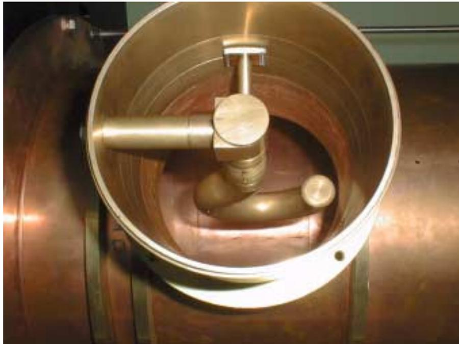
FIG. 1.12 – Installation du coupleur monopolaire sur le tube de la cavité, la boucle est parallèle à l'axe faisceau
