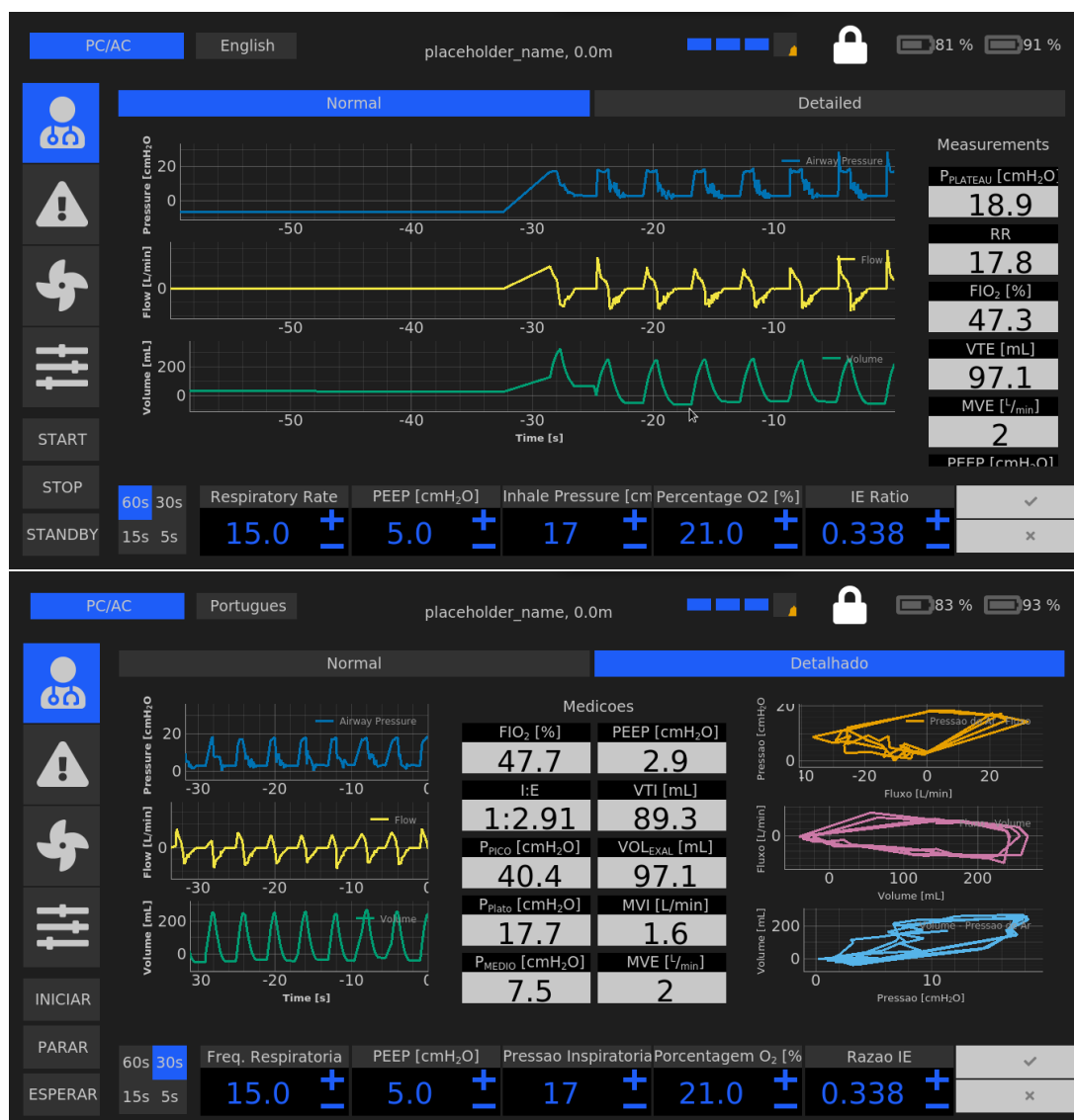
Figura 5.6: Telas do ventilador HPLV em funcionamento. Em cima, a interface mostra a tela padrão em inglês, mostrando os gráficos de pressão, volume e fluxo, acima à esquerda vemos um botão com a linguagem escolhida. Clicando no botão a interface mudará para português, tela detalhada abaixo, com gráficos mais detalhados.
