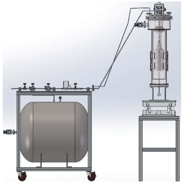
图 11 (在线彩图)固态氢靶系统的设计图 设计图左右两部分分别为氢气的输入输出单元和靶室主体单元。
