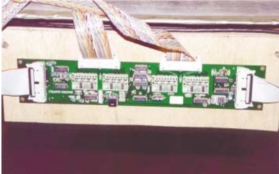
Figura 6: Fotografia do cartão SGS-Thomson-32ch usado para leitura digital dos sinais de módulos de strips .
