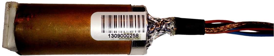
Abbildung 7.4.: APD-Vorverstärker-Einheit mit elektr. Isolation, Verkabelung und Barcode-Aufkleber.
