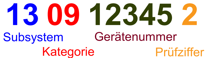
Abbildung 7.3.: Barcode-Nummerierungsschema für die Komponenten und Bauteile des PANDA-Detektors
