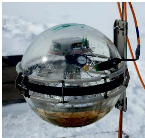
Рис. 34. Схематичный вид полномасштабного нейтринного телескопа Baikal-GVD (вверху). Оптический модуль перед погружением под лед (внизу). Из [332]
