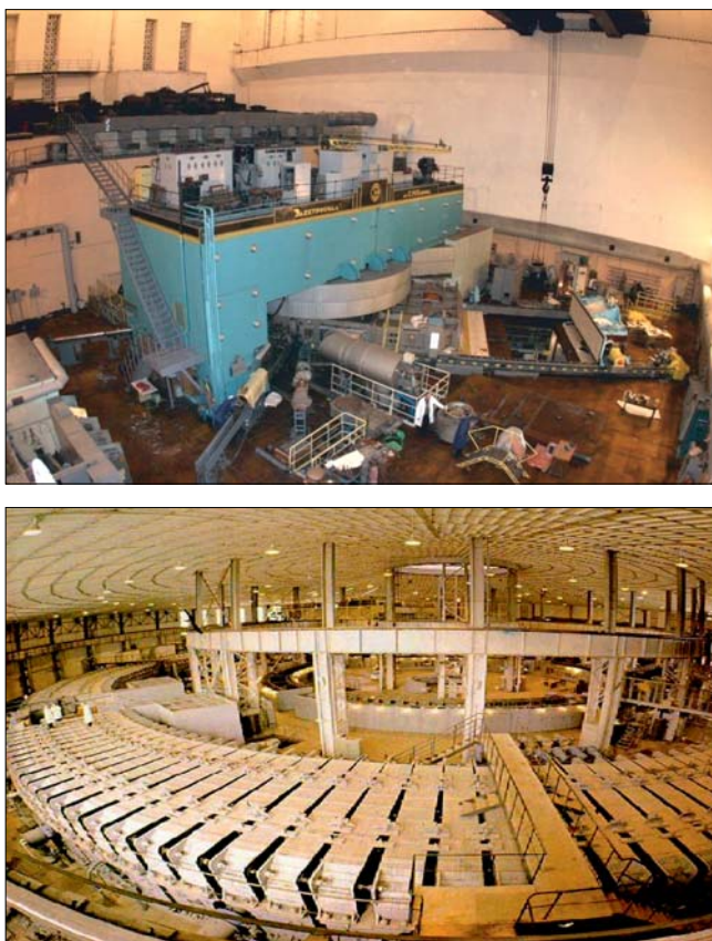
Рис. 1. Синхроциклотрон (вверху) и синхροфазотрон (внизу) — первые ускорители Дубны
