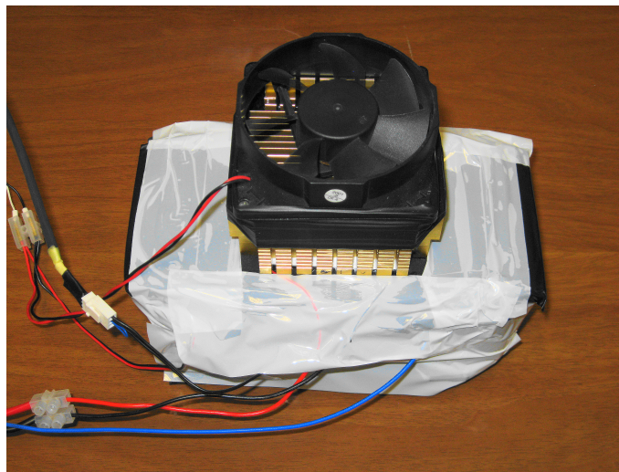
Figura A.1: La cella Peltier realizzata dall'INFN di Ferrara ed utilizzata per la caratterizzazione dei SiPM. Si possono individuare la ventola utilizzata per il raffreddamento e, sotto il nastro bianco, lo strato nero per l'isolamento ottico
