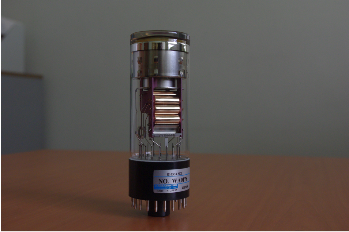
FIGURE 2.1 – Un exemplaire de photomultiplicateur Hamamatsu R10533.
