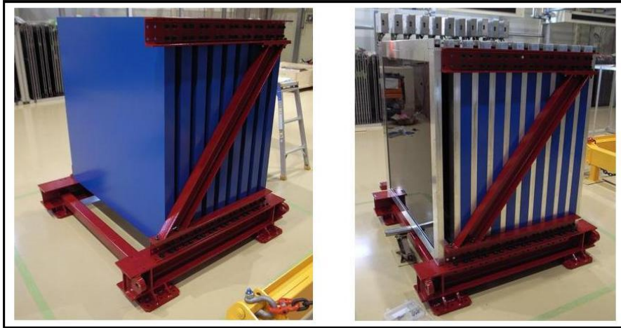
FIGURE 3.9 – Montage d'un module d'INGRID. Ce module correspond au module horizontal placé au centre de la croix (sans veto).
