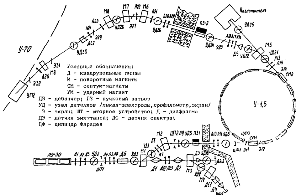
Р и с . 1. Схема расположения устройств диагностики каналов транспортировки пучка бустера.
