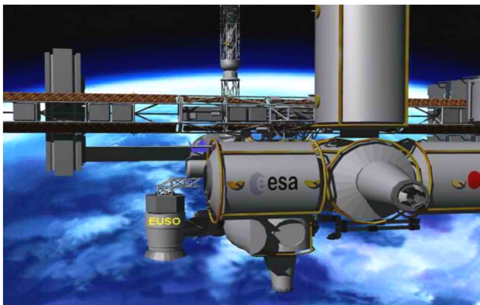
Figure 2. 7 : vue d'artiste d'EUSO accroché au module Colombus de l'ESA sur l'ISS
