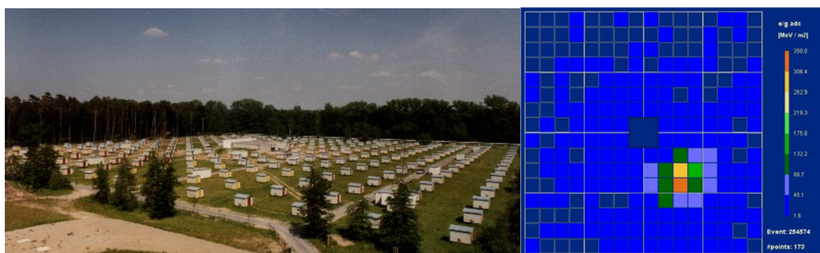
Figure 2. 2 : réseau de l'expérience KASCADE et image d'une gerbe atmosphérique par ce réseau
