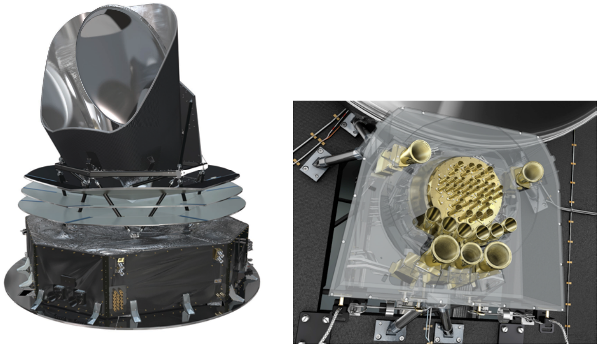
Figure 1.5 – Le satellite Planck et son plan focal. Gauche : Vue d'artiste du satellite. On voit de haut en bas : le télescope et son baffle, les trois ailettes de refroidissement, le module de service et les panneaux solaires (de dessous). Droite : Vue d'artiste du plan focal. Les cornets internes correspondent à l'instrument HFI, les cornets externes sont ceux de LFI. Crédits : ESA-Medialab.
