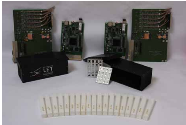
Figura 3.34: LET assemblato, cristalli di LYSO, SiPM montati sul supporto e schede dell'elettronica di front-end.
