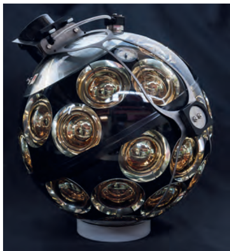
Figure N.4: De KM3NeT optische module met gevoelige lichtdetectoren.
