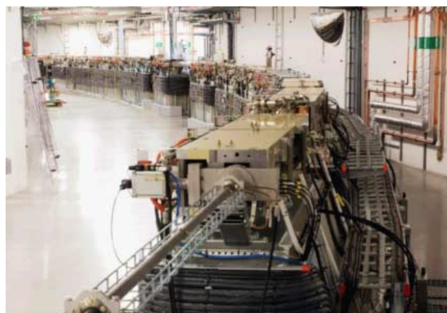
Рис. 17. Накопитель MAX IV. Видна последовательность идентичных магнитных блоков. На переднем плане — малоапертурная вакуумная камера прямолинейного промежутка.
