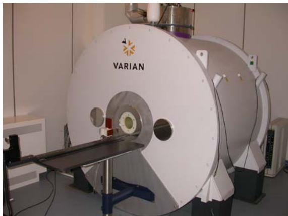
Abbildung 8.1: Supraleitender Magnet des Instituts für Neurowissenschaften und Medizin, B = 7 \text{ T} .
