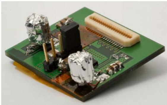
Abbildung 7.16: Photographie des TypL-Tor mit kleiner geschirmter Toroidspule.
