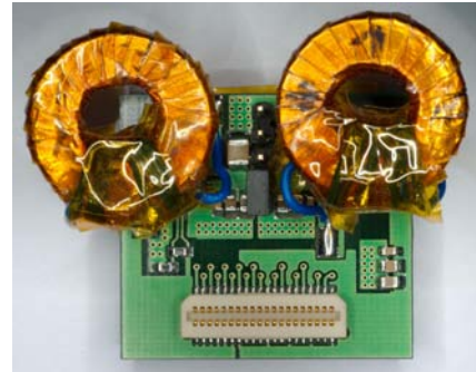
Abbildung A.20: Photographie des TypL-Tor mit Kupferbandtoroidspule.
