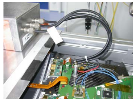
Abbildung 10.4: Photographie der geschlossenen Aluminiumbox mit der Stromzange. Die Ausgangsleitungen sind mit dem Spannungsversorgungseingang des Detektormoduls verbunden.
