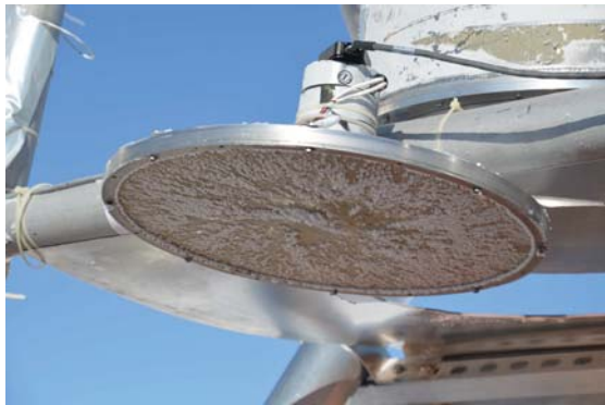
(d) Freezing fog on half-wave plate
